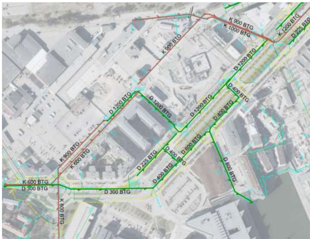
FIGUR 12. DAGVATTEN- OCH KOMBINERAT SYSTEM INOM DELAVRINNINGSMRÅDE 1. LEDNINGAR I GRÖN VISAR DAGVATTENLEDNINGAR. LEDNINGAR I BRUN VISAR KOMBINERADE LEDNINGAR.
