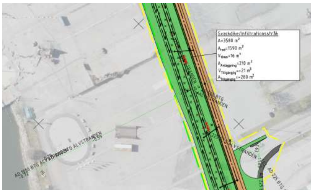
FIGUR 34. FÖRESLAGEN DAGVATTENHANTERING VID NY GATA OCH GC-VÄG I FRIHAMNEN
