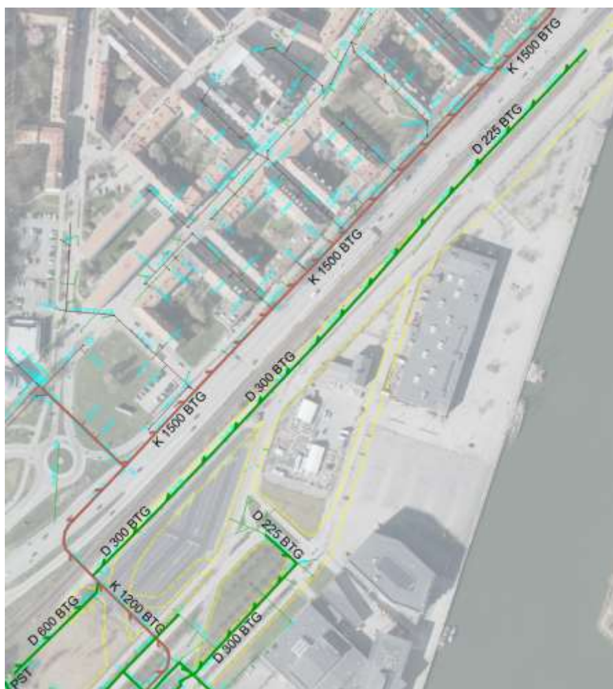
FIGUR 14. DAGVATTEN- OCH KOMBINERAT SYSTEM INOM DEN NORRA DELEN AV DELAVRINNINGSOMRÅDE 2. LEDNINGAR I GRÖN VISAR DAGVATTENLEDNINGAR. LEDNINGAR I BRUN VISAR KOMBINERADE LEDNINGAR.
